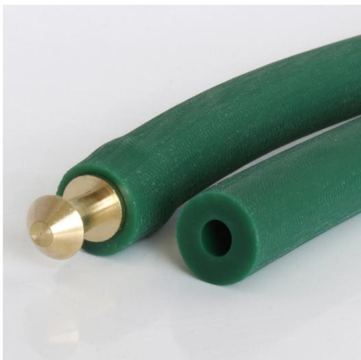
Esta correas pueden comprarse por metro lineal (abiertas) para luego ser cortadas a la medida deseada y soldarse por los extremos mediante la aplicación de calor. Las correas tubulares se pueden unir también mediante un pequeño accesorio que se inserta en ambas puntas, provisto por el fabricante.
